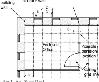
Note 1—A = 50 mm [2 in.] B = 100 mm [4 in.] C = 600 mm [24 in.] D = 700 mm [28 in.]
